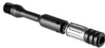
\* Los pistones Vepr y Saiga requerirán perforar el op-rod después de atornillar el pistón en el portador, debido a variaciones en la ubicación de la fijación. Estos op-rods están fosfatados en lugar de nitrurados para permitir una perforación fácil.\*
