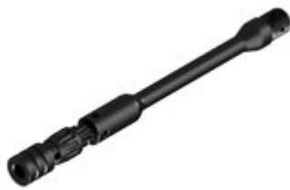
\* Los pistones Vepr y Saiga requerirán perforar el op-rod después de atornillar el pistón en el portador, debido a variaciones en la ubicación de la fijación. Estos op-rods están fosfatados en lugar de nitrurados para permitir una perforación fácil.\*
